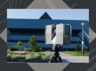
KLAS S.p.A. utilizza Laser Scanner FARO Focus M 70, un potente scanner laser 3D, per effettuare scansioni sia in ambienti interni che esterni, fino a 70 metri di profondità.
